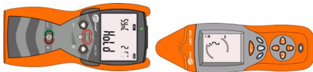
Fig. 5 La disposizione del trasmettitore e del ricevitore durante la sincronizzazione
